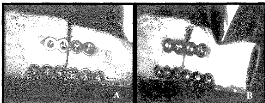
FIGURA 42 - Final do teste. Deslocamento em "V" da costela (A) e torção da costela e das placas (B).
