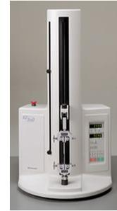
**Figura 44:** Ensaio de microtração.
