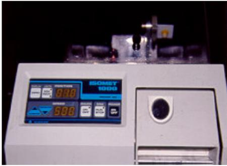
**Fig. 35:** Cortadeira de precisão utilizada para obtenção das fatias.
