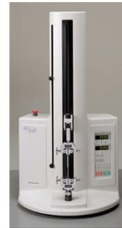
**Fig. 38:** Equipamento utilizado para o ensaio de microtração.
