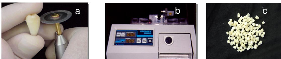
**Figura 1:** Remoção das raízes dos terceiros molares (**a**); Cortadeira metalográfica utilizada para obtenção dos blocos de esmalte(**b**); blocos obtidos com área aproximada de  $16 \text{ mm}^2$  (**c**).
