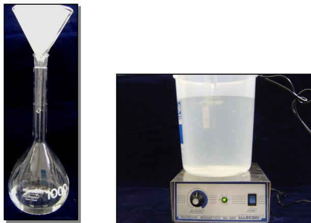
**Figura 23:** Solução coada após 96 horas de saturação e mistura dos dois litros de solução. Nova verificação do pH e acréscimo de NaF.
