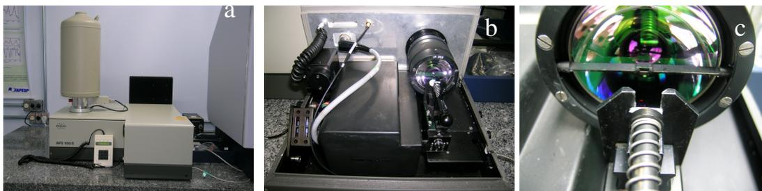
**Figura 5:** Espectroscópio Raman com Transformada de Fourier (a); visualização do compartimento interno do aparelho (b) e das lentes IR354 que coletam a radiação laser (c).
