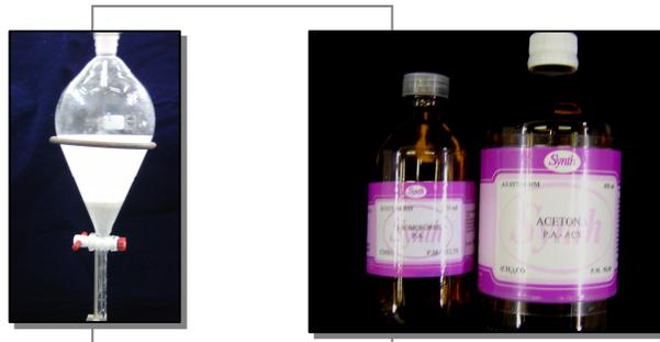
**Figura 17:** Funil de separação contendo solução bromofórmio-acetona, para separação do esmalte da dentina.
