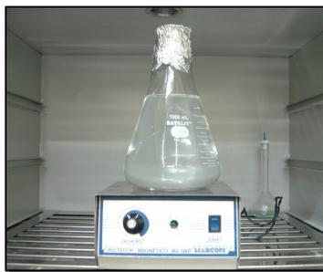
**Figura 22:** Solução contendo o pó de esmalte em estufa a 37°C durante 96 horas sob agitação.
