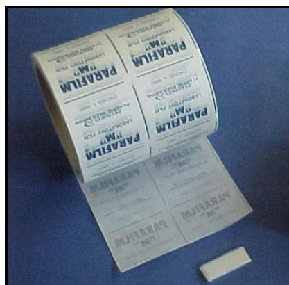
Figura 8 - Rolo de Parafilm® e recorte do material já dobrado em forma de goma de mascar.
