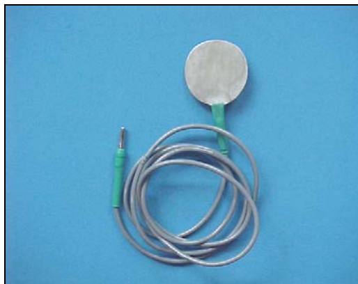
Figura 5 – Eletrodo de referência (FOP/UNICAMP)
