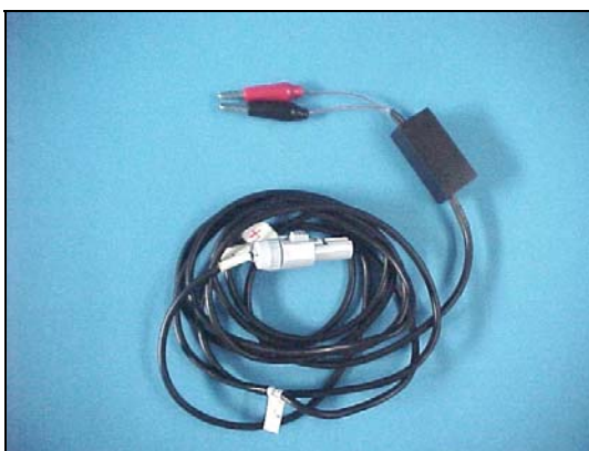
Figura 4 – Pré-amplificador PA 1010 -VA (Lynx Tecnologia Ltda)
