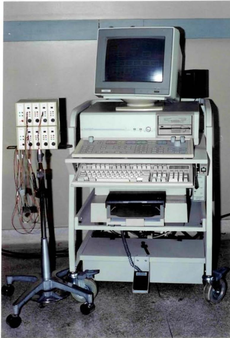
**Figura 2** - Eletromiógrafo VIKING II de oito canais, computadorizado com impressora a jato de tinta, da Nicolet Biomedical Instruments.
