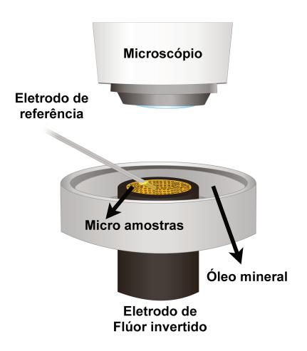
Ilustração do aparelho utilizado para microanálise de fluoreto. As amostras foram posicionadas na superfície do cristal íon-específico do eletrodo de flúor invertido, sob óleo mineral, e diluídas com TISAB III (10:1). Com o auxílio de um microscópio, o microeletrodo de referência foi posicionado em contato com as amostras, fechando o circuito e permitindo a determinação da concentração de fluoreto através de um potenciômetro.
