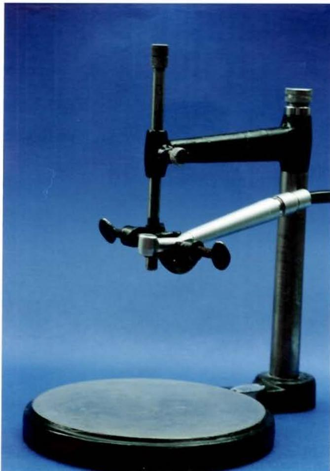
Fig. 4 - Peça-de-mão de alta-rotação adaptada à haste vertical móvel do segundo delineador através de uma braçadeira.
