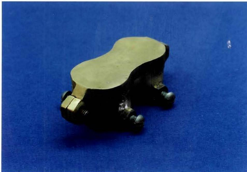
Fig. 16 - Aspecto externo da matriz, para a reprodução do corpo de prova.
