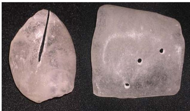
**Figura 5** – Guias de resina acrílica para o corte sagital e para perfuração e inserção dos parafusos.
