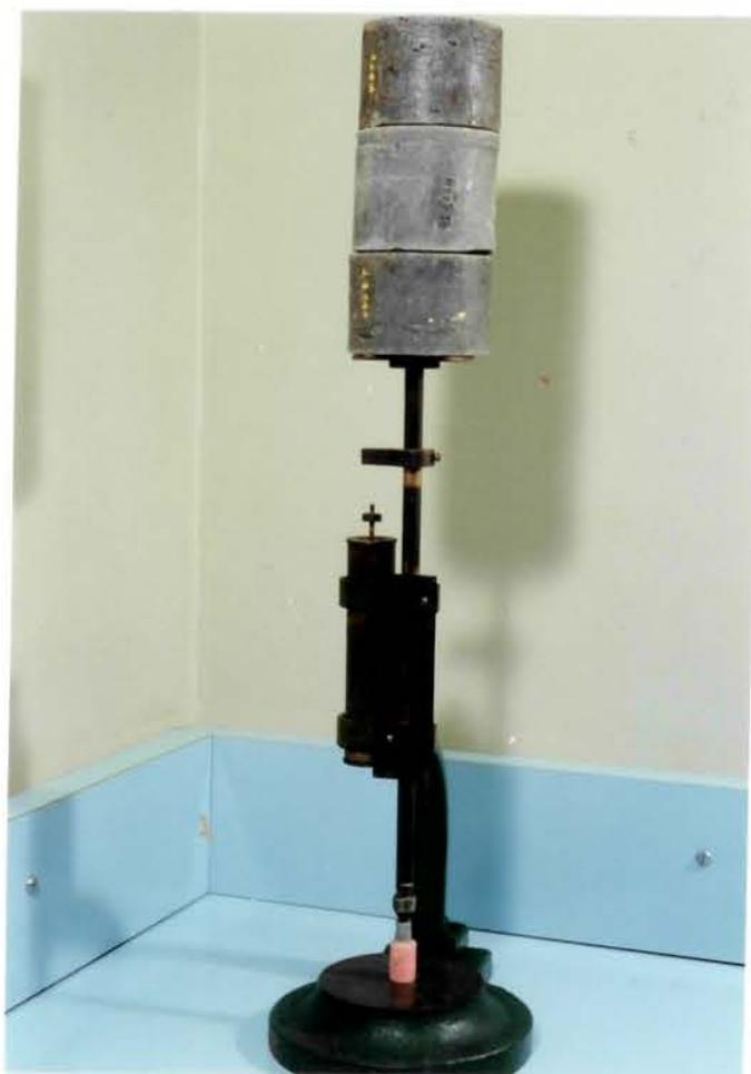
*Figura 6- Corpo de prova cimentado, submetido ao dispositivo axial de compressão com carga estática de 15Kg/15 min.*
