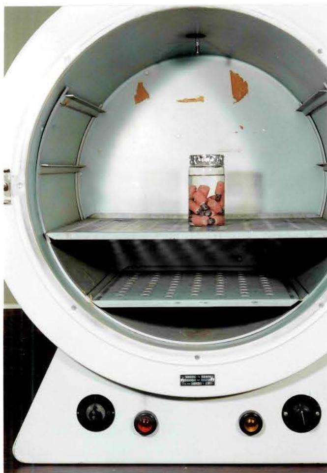
*Figura 7- Corpos de prova em uma estufa a 37 °C acondicionados em recipiente contendo soro fisiológico a 0,9%.*
