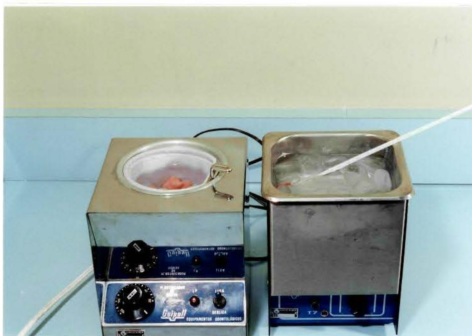
*Figura 8 - Corpos de prova submetidos a ciclagem térmica manual.*
