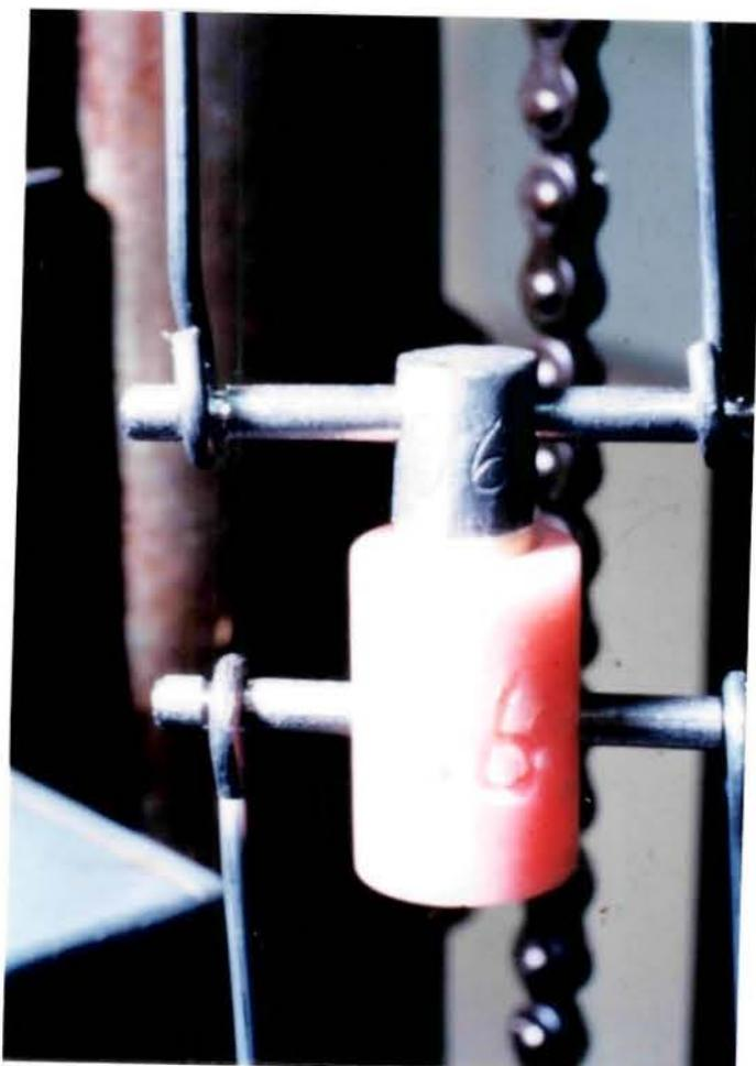
*Figura 9 - Ensaio de teste de tração.*
