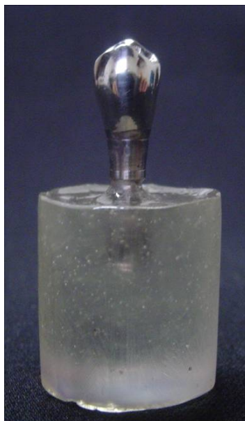
Figura 1: matriz metálica usada para confeccionar as coroas em resina acrílica
