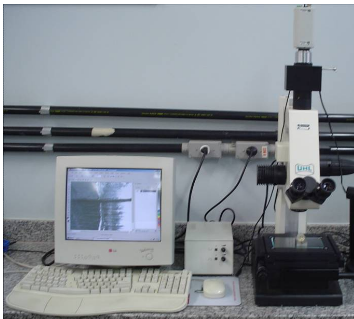
Figura 5: Microscópio digital de medida Walter Uhl, Asslar, Alemanha
