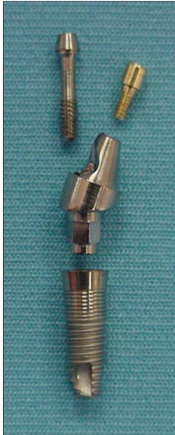
Figura 3: foto que mostra os parafusos avaliados e o intermediário Estheticone angulado
