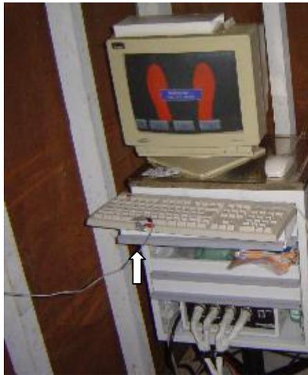
Figura 3 – Chave interruptora instalada no teclado do computador conectado ao estabilômetro e ao gatilho externo do eletromiógrafo.
