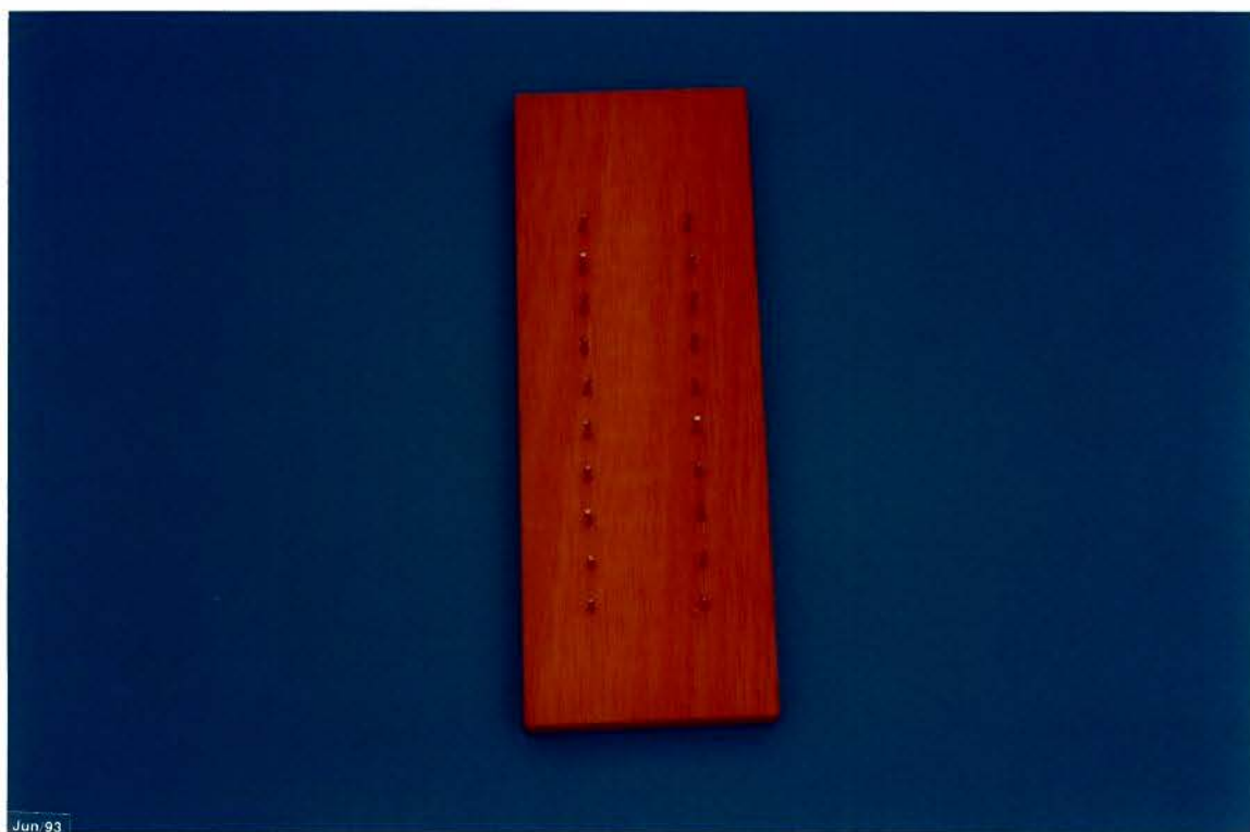
Fig. 4.4 - Base de madeira, cada uma com 10 pares de pinos metálicos, fixados à distância de 25 mm entre si e a 10 mm entre os pares de pinos.
