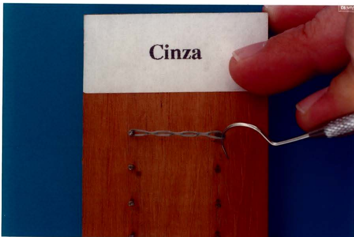
Fig. 4.7 - Distensão de uma amostra nos pares de pinos da base de madeira, com o auxílio da sonda clínica exploradora nº 5
