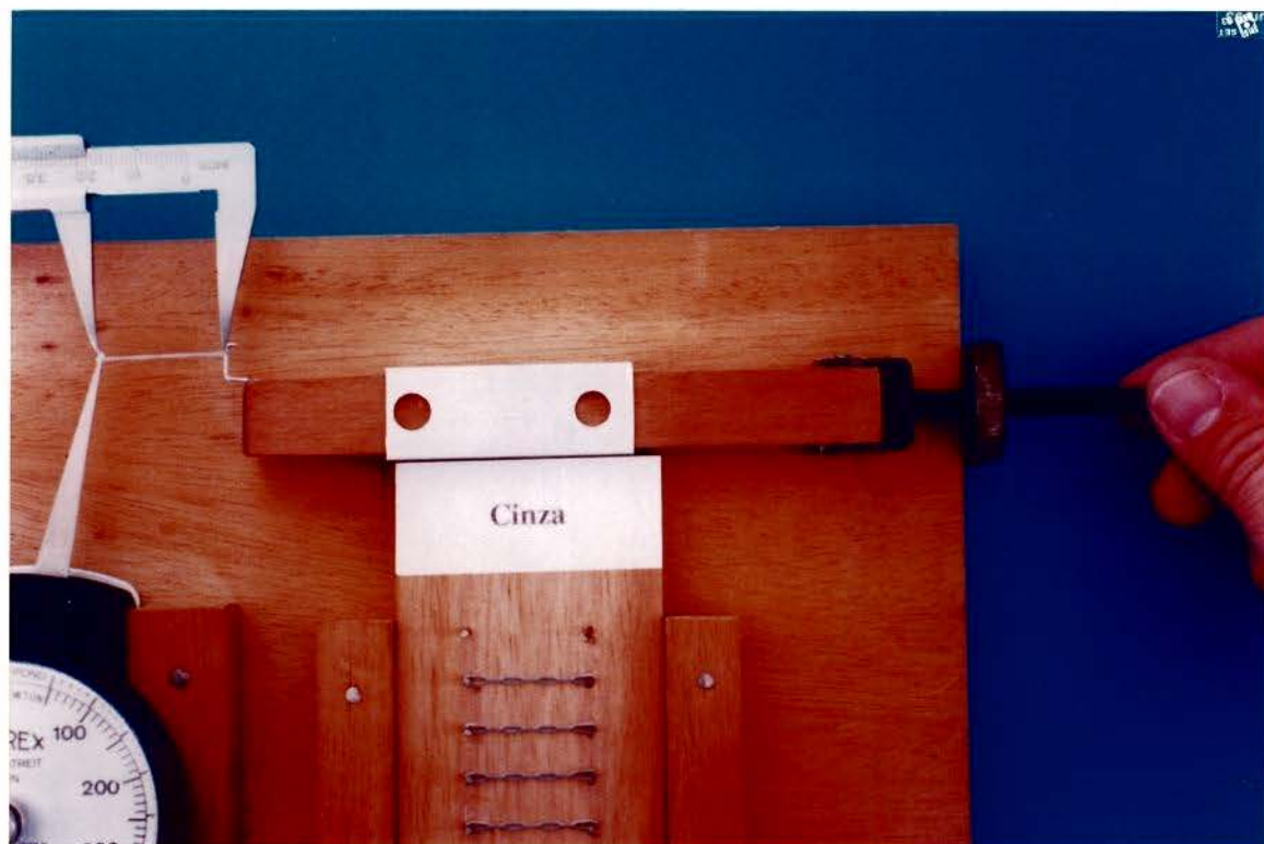
Fig. 4.11 - Calibragem da distância entre a haste do dinamômetro e o cursor, sendo esta medida conferida com o auxílio do paquímetro.
