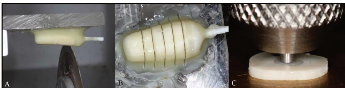
Figura 4. A. Amostra aprisionada na cortadeira. B. Corte das fatias. C. Teste de push out .
