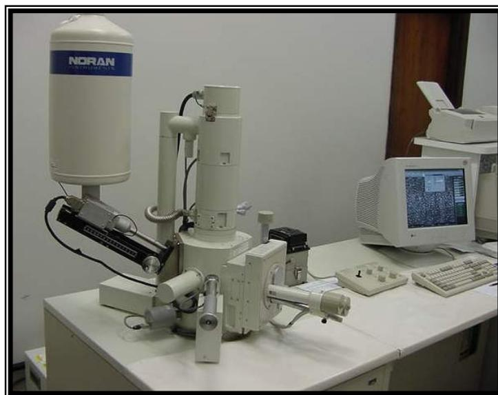
Figura C. Microscópio Eletrônico de Varredura.
