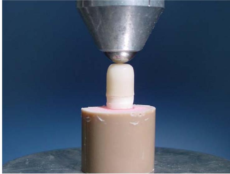
Figura 10 – Corpo-de-prova posicionado na Instron para ensaio de resistência à fratura.
