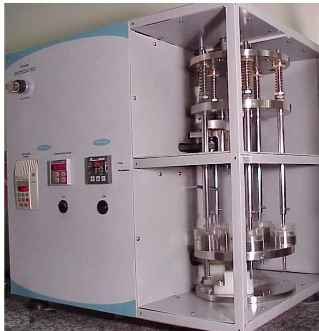
Figura 12 – Máquina de ensaio de fadiga
