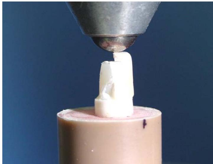
Figura 11 – Corpo-de-prova fraturado após ensaio de resistência à fratura.
