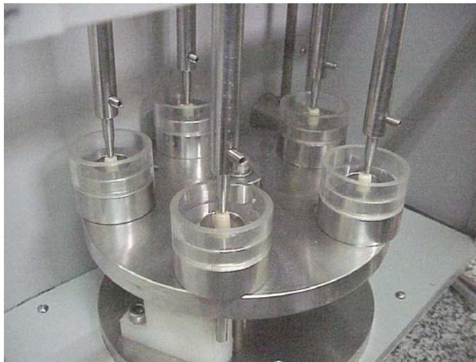
Figura 14 – Corpos-de-prova durante ensaio de fadiga à seco.
