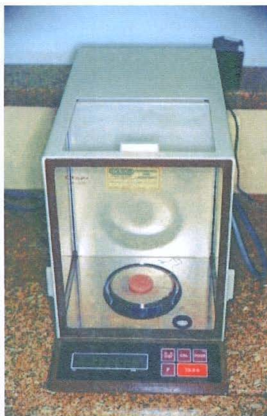
FIGURA 6 – Amostra do Coe-Soft pesada em balança analítica de precisão
