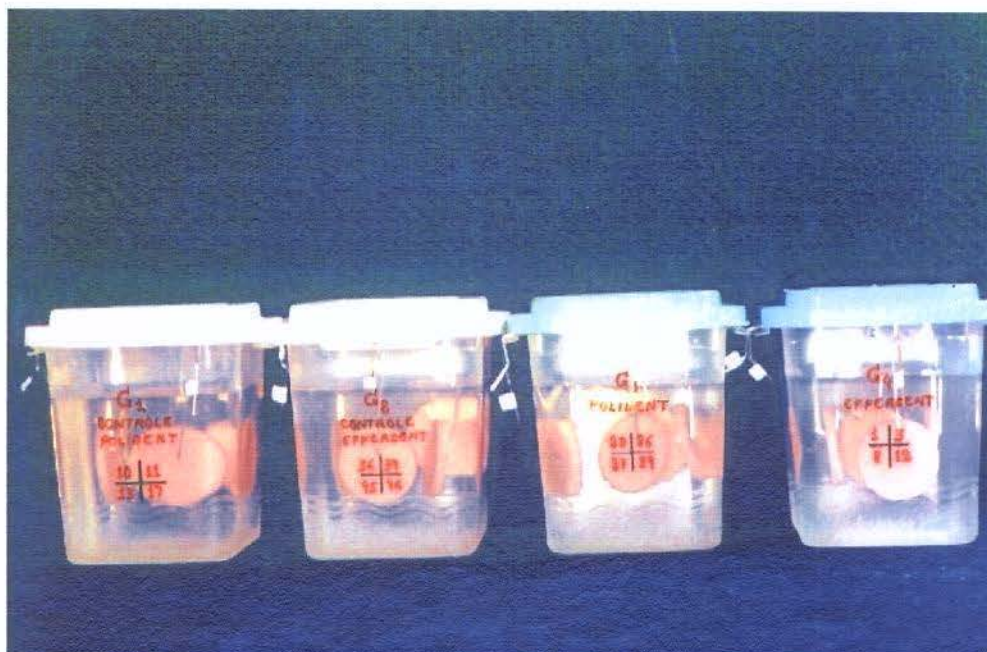
FIGURA 10 – Amostras dos grupos controles e experimentais imersas em saliva artificial para serem armazenadas
