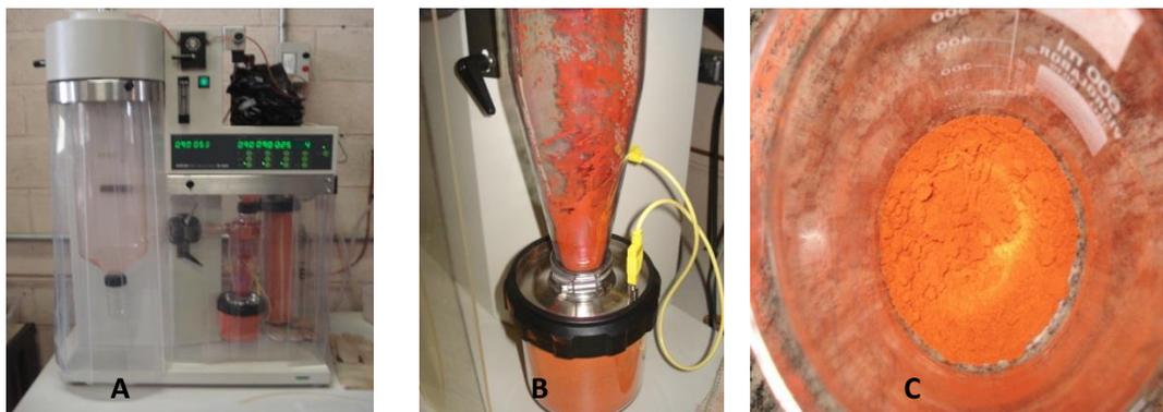
**Figura 23:** Secagem do extrato bruto de *A. chica* por *Spray Dryer*.
