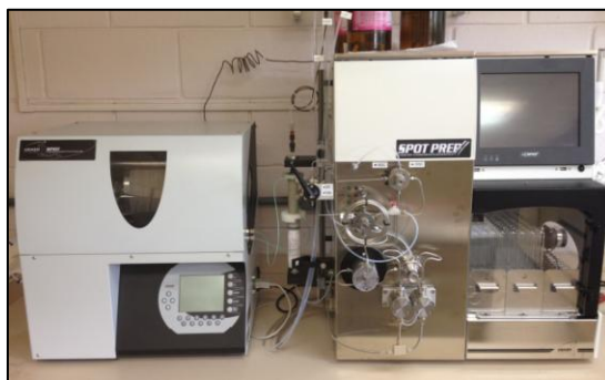
Figura 20 - Cromatógrafo de Partição Centrífuga utilizado na purificação do espilantol.
