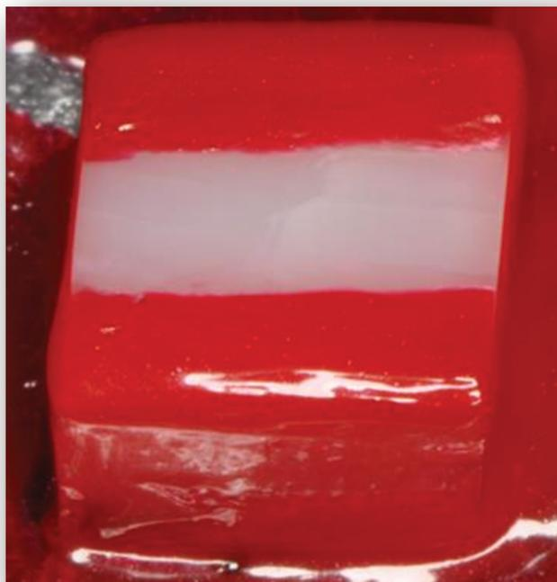
Figura 02 – Espécime coberto com verniz ácido resistente (vermelho), deixando exposta uma área de 2 x 5 mm (branca).
