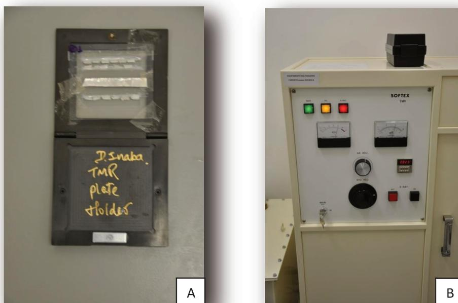
Figura 20 (A e B) – A: As amostras dispostas em placa de PVC e montada no cassete; B: O equipamento de RX da TMR.
