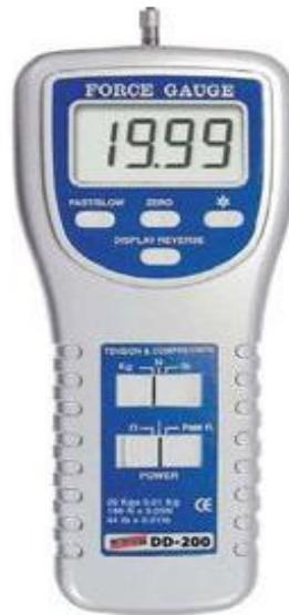
**Figura 4:** Algômetro digital da marca Instrutherm modelo DD-200.
