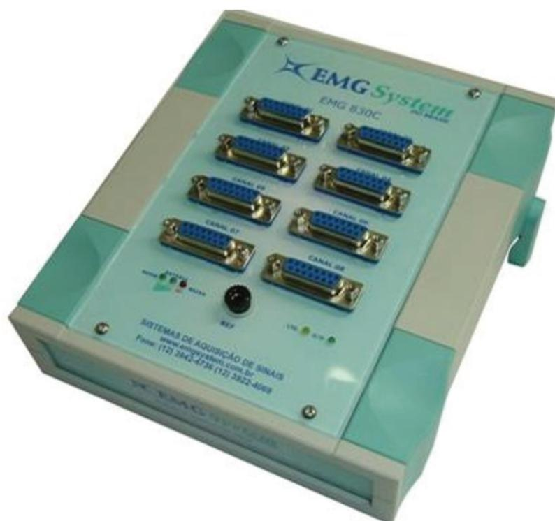
**Figura 1:** Módulo de aquisição de sinais da marca EMG System modelo EMG 830 C.
