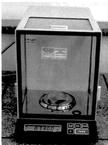
**Figura 9:** Silicone por adição pesado em balança de precisão.
