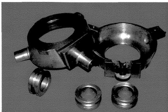
**Figura 6:** Mufla metálica específica para técnica de injeção.
