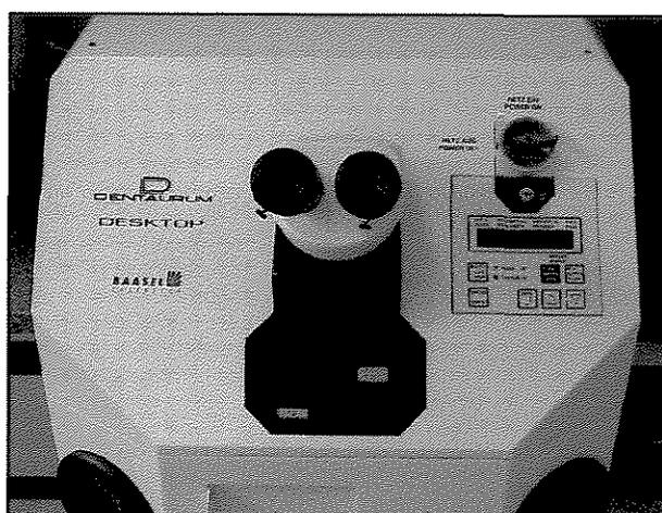
**FIGURA 3.6.** - Máquina de soldagem a laser.
