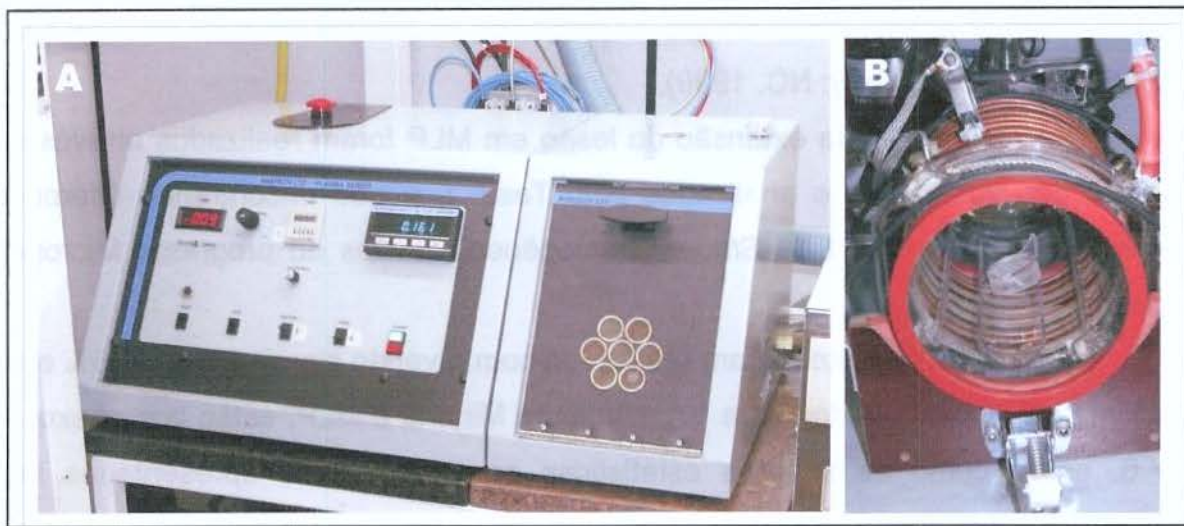
Figura 10 – A- Aparelho utilizado para a aplicação de plasma de argônio nas amostras. B- Detalhe da amostra na câmara de vácuo.
