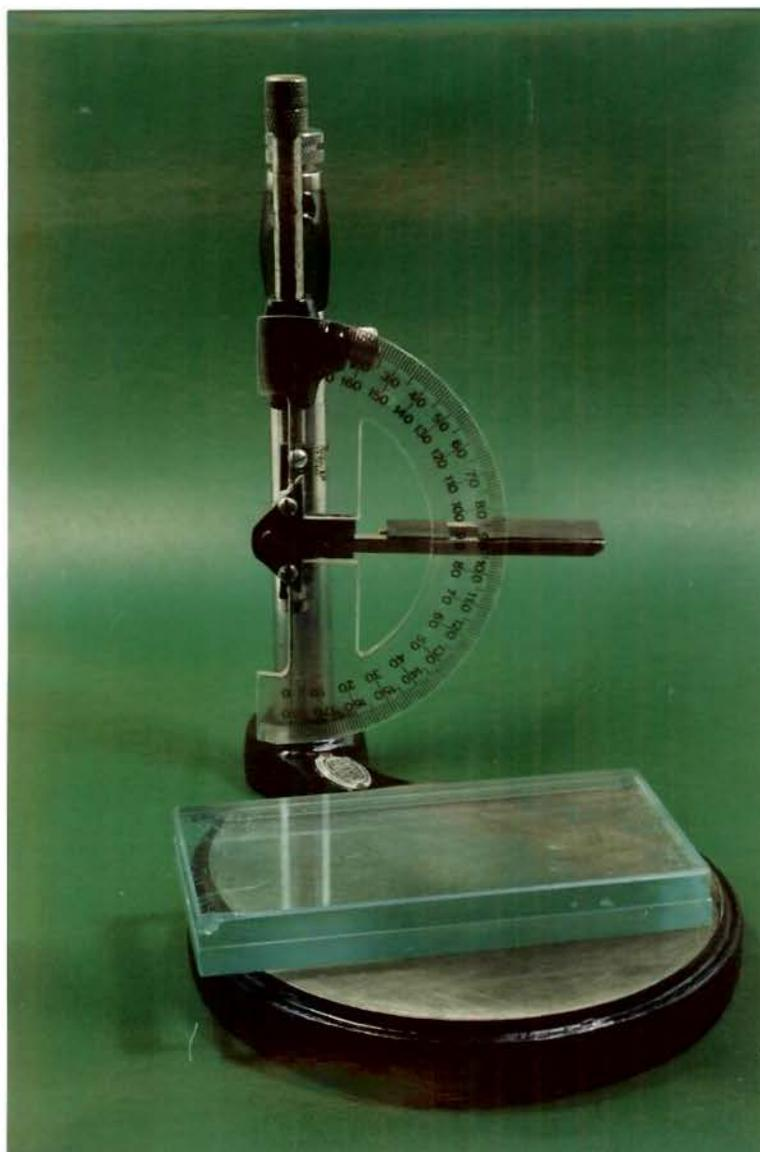
FIG. 3 - Transferidor e compasso adaptados à haste vertical móvel do delineador.
