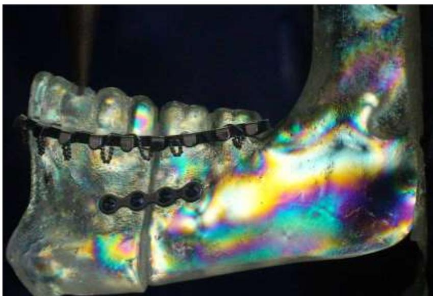
Figura 9 - Teste Vertical – Deslocamento de 3 mm. Grupo II.
