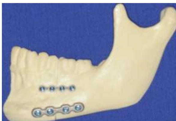
Figura 4 – Hemimandíbula do grupo IV, fixada com uma placas do sistema 2,0mm na zona de tensão e uma placa do sistema 2,4mm na zona de compressão.
