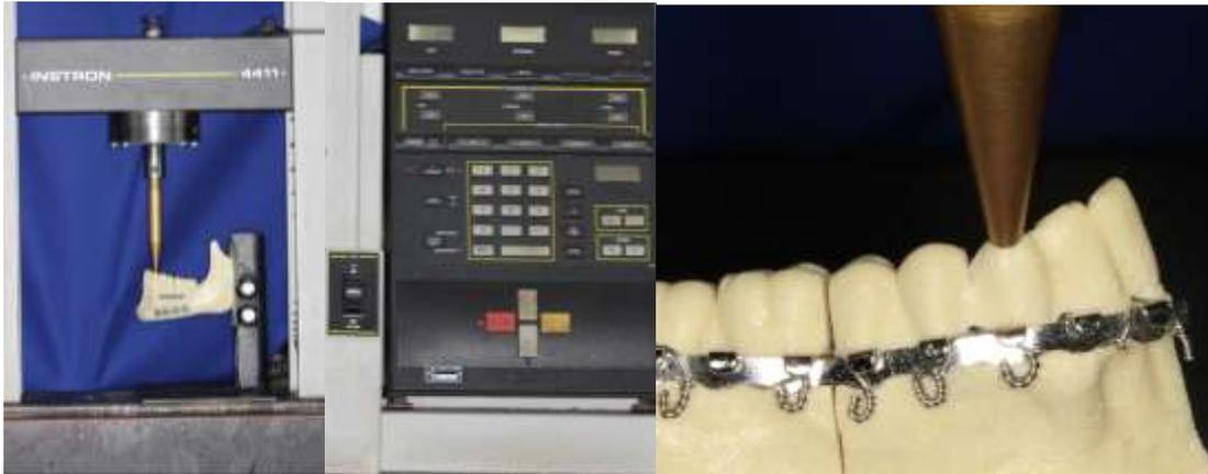
Figura 3. Incidência da carga axial no canino do modelo mandibular de Poliuretano.
