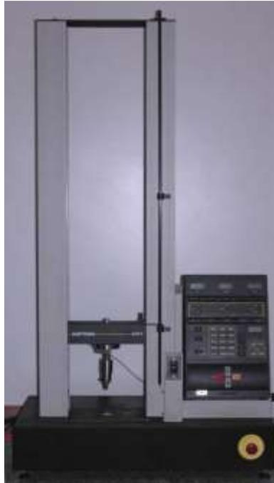
Figura 1. Máquina de ensaio universal Instron® 4411.
