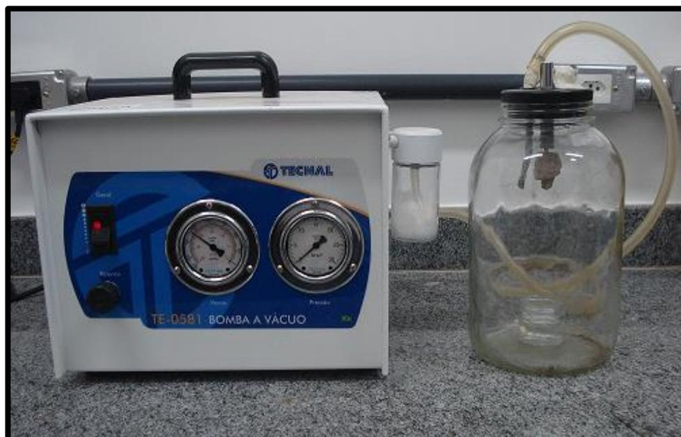
Figura 8. Bomba á vácuo para a infiltração em resina acrílica autopolimerizável.
