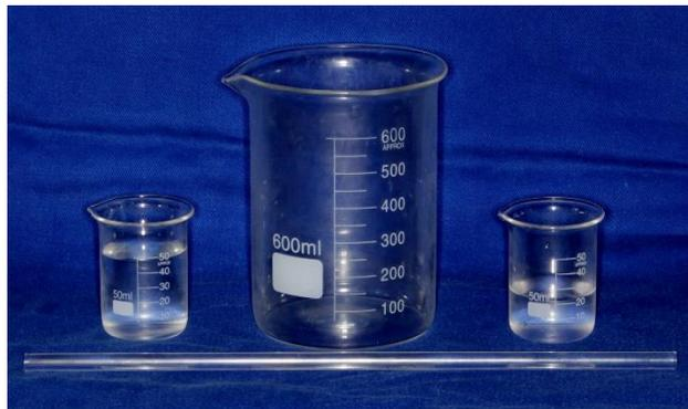
Figura 7 - Beckers e bastão de vidro utilizados para manipulação da resina fotoelástica.
