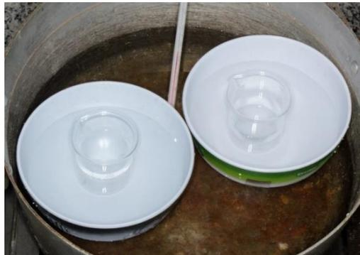
Figura 8 - Aquecimento da resina e do endurecedor.
