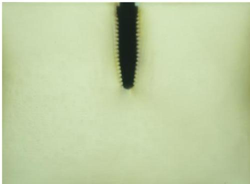
Figura 9 - Modelo fotoelástico
