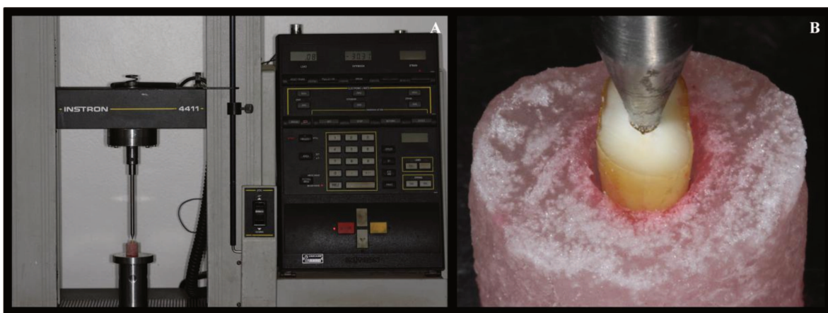
Figura 3 - (A) Dente posicionado na máquina de ensaio universal; (B) Dente disposto no bloco de acrílico com a ponta metálica introduzida na entrada do canal radicular.
