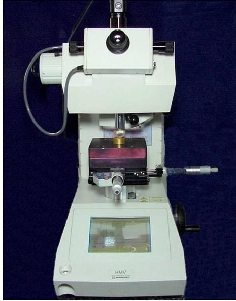
Figura 5 – Microdurômetro.
