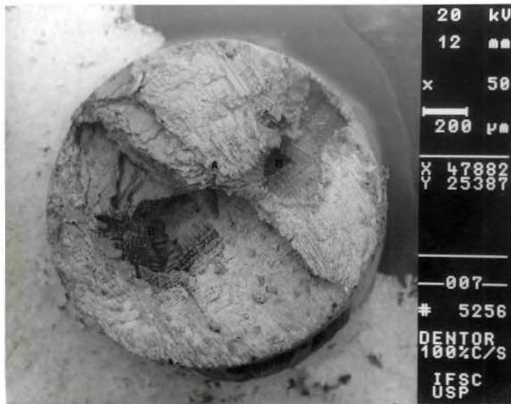
FIGURA 5.12 - Fotomicrografia por microscopia eletrônica de varredura da liga Dentorium nova com solda fraturada com 1.024 ciclos (aumento de 50 X):
