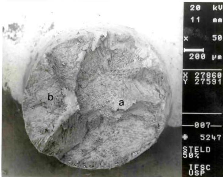
FIGURA 5.7 - Fotomicrografia por microscopia eletrônica de varredura da liga Steldent refundida, sem solda, fraturada com 4.414 ciclos (aumento de 50 X):
