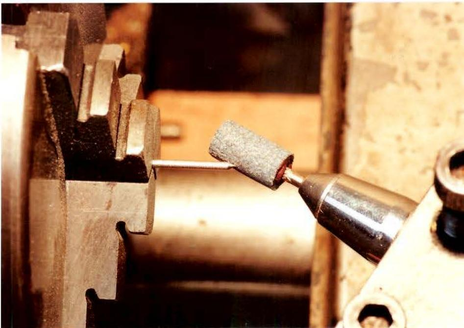
FIGURA 4.3 - Usinagem das extremidades para soldagem.
