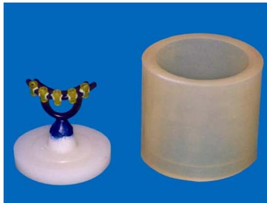
**Fig.3:** Estrutura encerada e anel de silicone.
