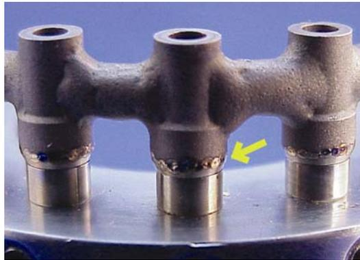
**Fig.7:** Pontos de solda entre a interface estrutura/cilindro de titânio.
