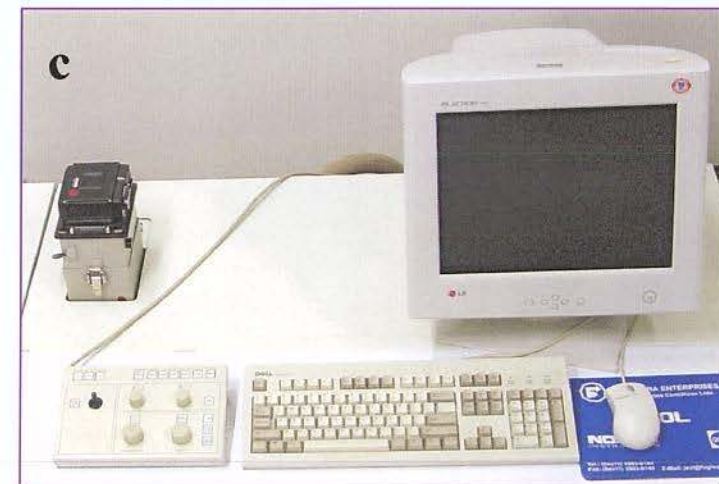
a) Metalizadora; b) Microscópio Eletrônico de Varredura (MEV); c) Computador acoplado ao MEV.
