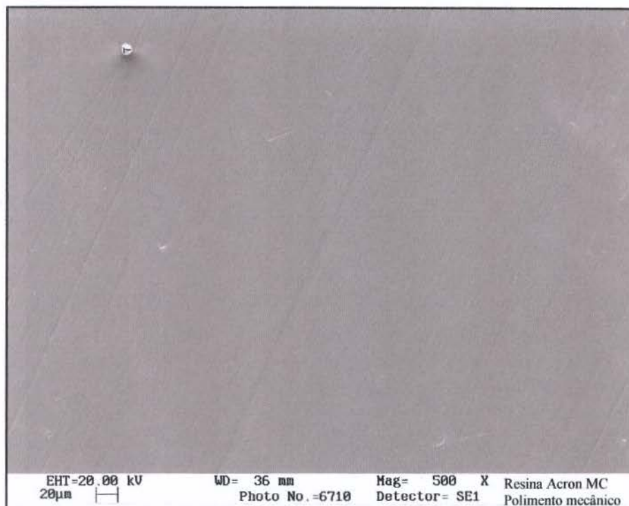
FIGURA 26 - Superfície da resina Acron MC submetida ao polimento mecânico, aumento de 500x.
