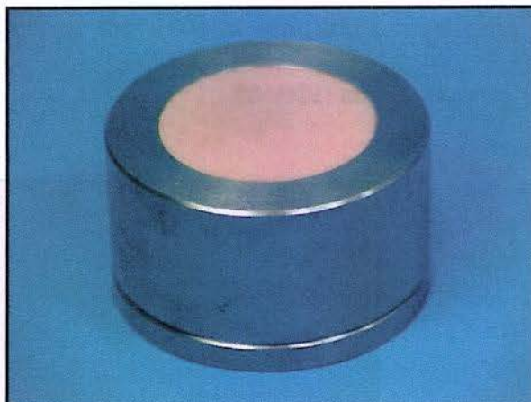
FIGURA 10 - Suporte em aço com a amostra em resina posicionada.
