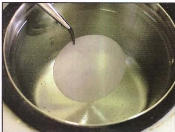
FIGURA 14 - Imersão da amostra em fluido para polimento químico.
