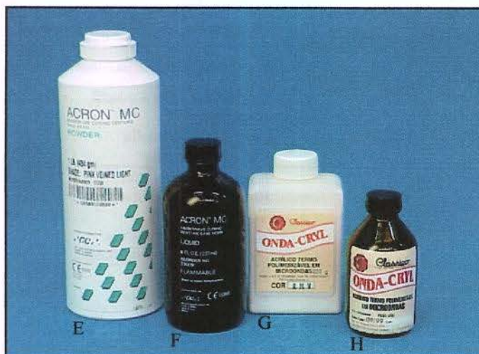
FIGURA 2 - Materiais utilizados: resina Acron MC, polímero (E) e monômero (F); resina Onda Cryl, polímero (G) e monômero (H).
