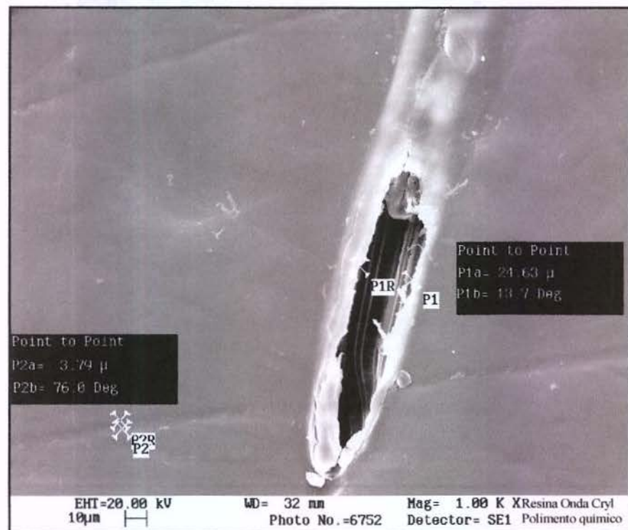
FIGURA 33 - Mensurações da cavidade (P1 - P1R) e de uma ranhura na superfície da resina acrílica (P2 - P2R), aumento de 1000x.
