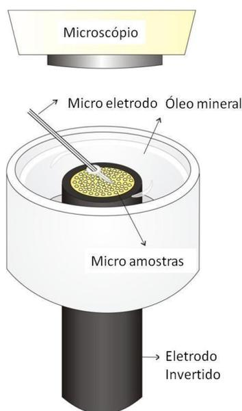
Figura 6. Eletrodo íon específico invertido adaptado para microanálise da concentração de F em amostras.
