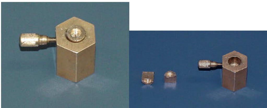
Figura 2 – Observa-se a matriz metálica bipartida utilizada para confecção dos corpos de provas
