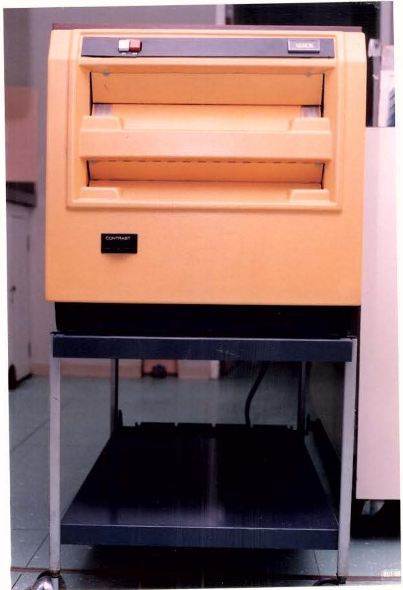
**Figura 1.** Unidade condicionadora do sistema 125 da Xerox. A condicionadora prepara automaticamente a placa xerográfica para a exposição aos raios X.
