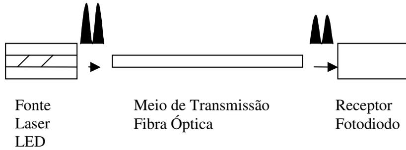
Figura 2.1 - Esboço de um sistema de transmissão óptica
