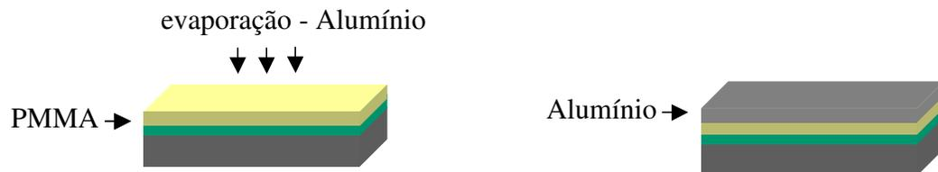
Figura 3.8: Etapa de deposição do filme de Alumínio sobre o filme de PMMA
