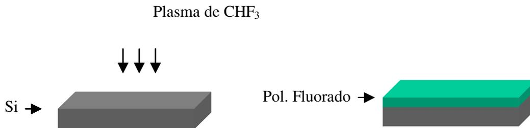
Figura 3.5: deposição do polímero parcialmente fluorado pela técnica de plasma
