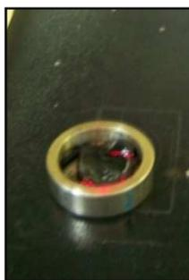
**Figura 3.12** Molde metálico cilíndrico contendo um resíduo pesado de petróleo
