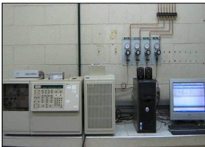
**Figura 3.10** Cromatógrafo Gasoso acoplado ao Espectrômetro de Massas (CG/EM) do LRAC/FEQ.
