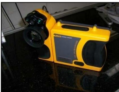
**Figura 3.14** Termógrafo utilizado para o monitoramento da temperatura na técnica do laser cracking.
