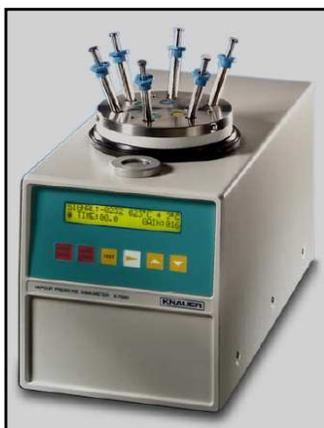
**Figura 3.2** Osmômetro de Pressão de vapor para a determinação do peso molecular pertencente ao laboratório LPDS/FEQ/UNICAMP.
