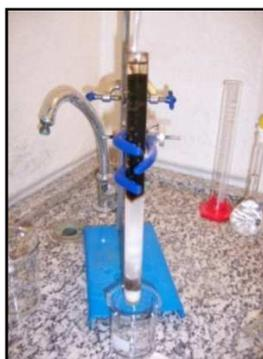
**Figura 3.9** Coluna cromatográfica aberta com a adição do solvente n-pentano puro.
