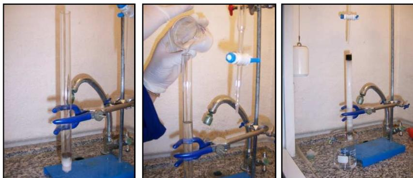
**Figura 3.8** Preparação da coluna cromatográfica aberta com a adição da amostra de petróleo.
