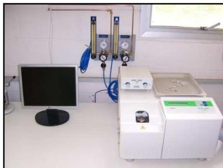
**Figura 3.3** Calorímetro diferencial de varredura (*DSC*) instalado no LOPCA/FEQ/UNICAMP
