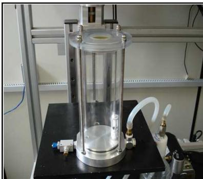
**Figura 3.13** Reator *laser cracking* para a irradiação dos resíduos de petróleo.
