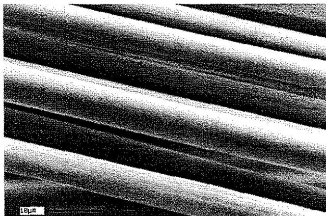
**Figura 5.4: Micrografia da superfície de filamento de fibra de carbono da amostra tratada com h de 15 mm por 15 segundos (15/15).**
