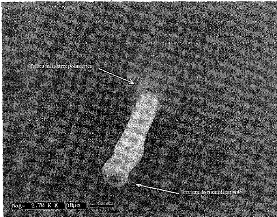
**Figura 5.23: Micrografia ilustrando o aspecto da adesão entre os constituintes e a trinca localizada próxima a matriz polimérica.**
