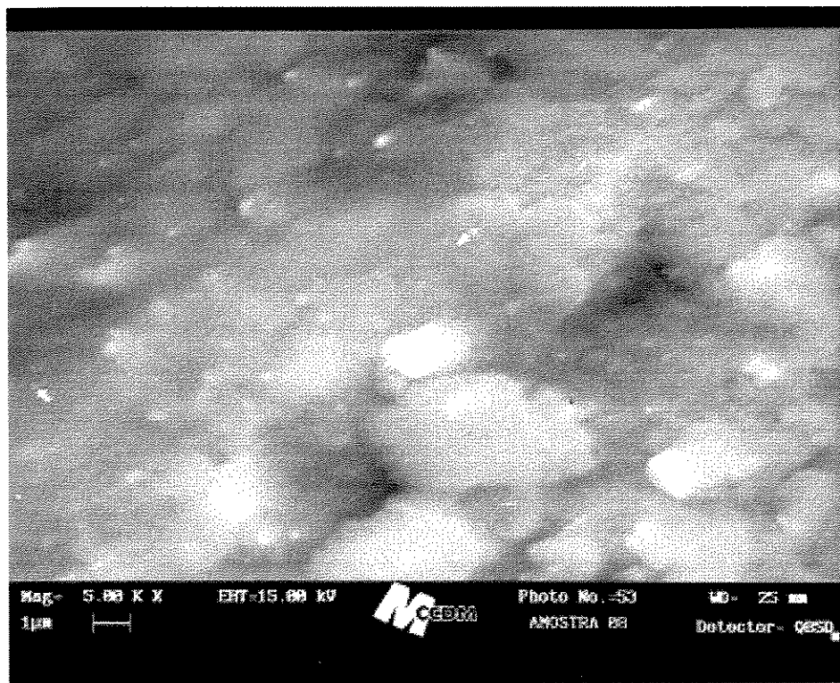
Figura 17 Fotomicrografia eletrônica de varredura do catalisador n°8 (10.0% Ag). Ampliação: 5000 vezes.
