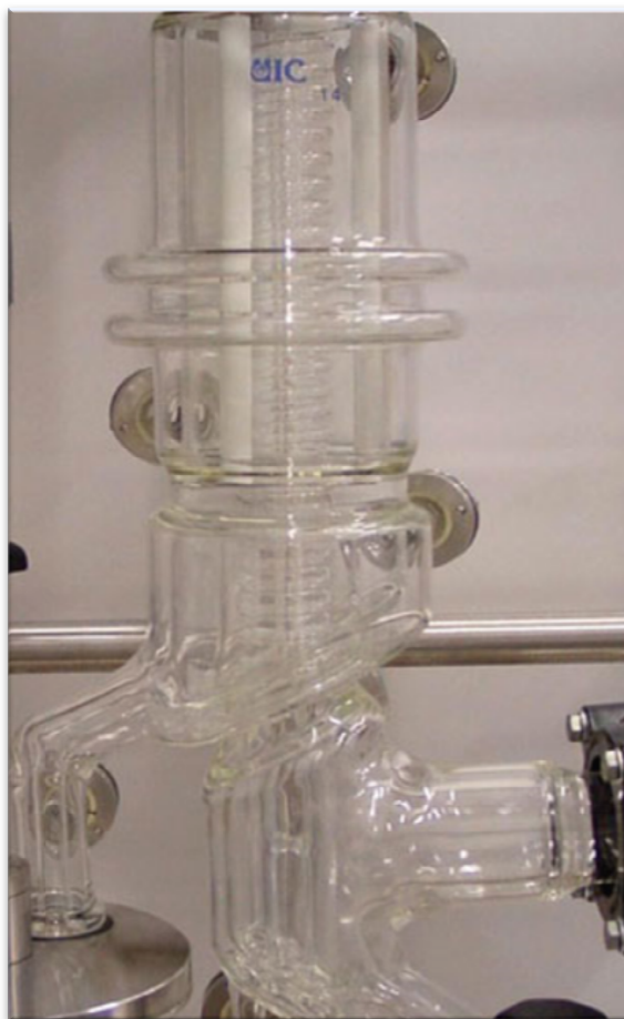
Figura 6. Foto do evaporador e do condensador do destilador molecular de filme descendente, modelo KDL-5. Fonte: UIC GmbH, 2009.
