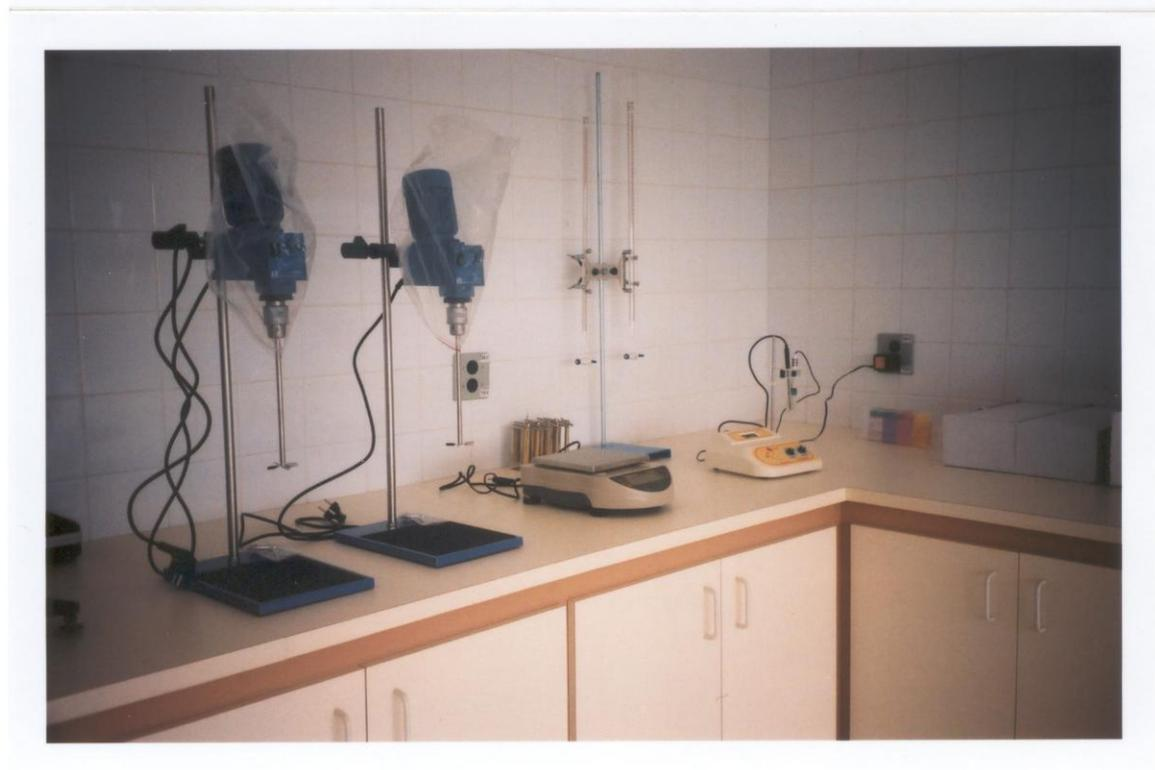
**Figura 23 – Equipamentos do laboratório da Cytec.** Estufa, dissecador, balança analítica, viscosímetro Brookfield, agitadores, balança eletrônica e pHmetro utilizados do laboratório da Cytec Brasil.
