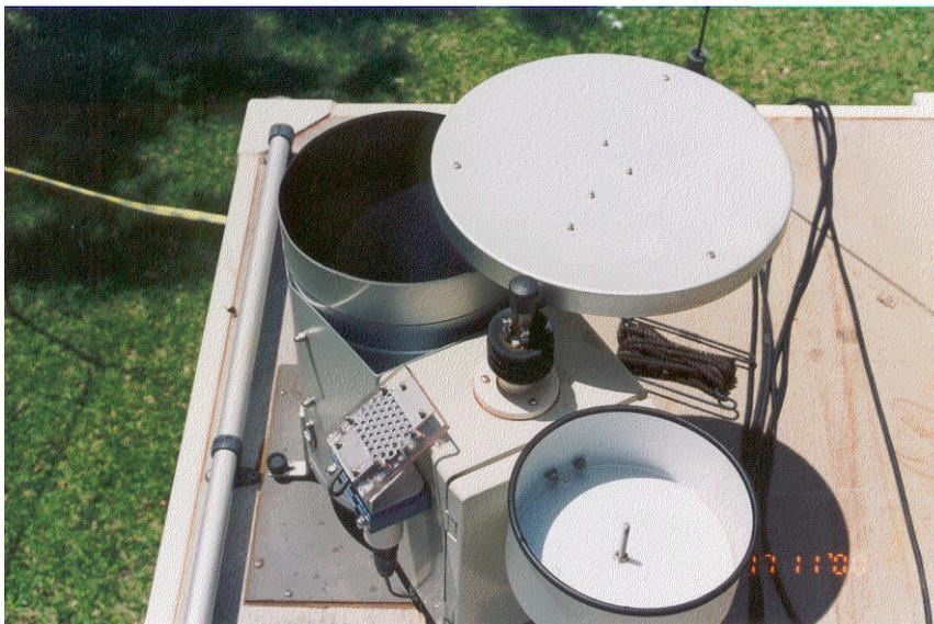
**Figura 3.5** – Coletores de água de chuva e de deposição seca
