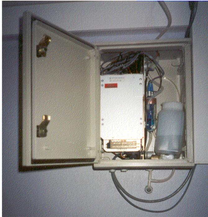
**Figura 3.6** – Eletrodos e sistema para medidas de pH e condutividade
