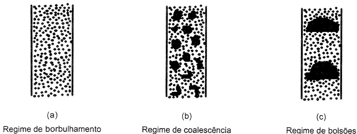
Figura 3 – Regimes de operação num reator de leito fluidizado trifásico segundo FAN (1989)
