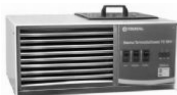
Figura 3.6. Banho termostático TECNAL, modelo TE 184. (Fonte: Tecnal, 2009.)
