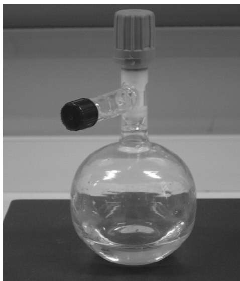
Figura 3.2. Recipiente para purificação, coleta e armazenamento dos líquidos iônicos utilizados nesta pesquisa.
