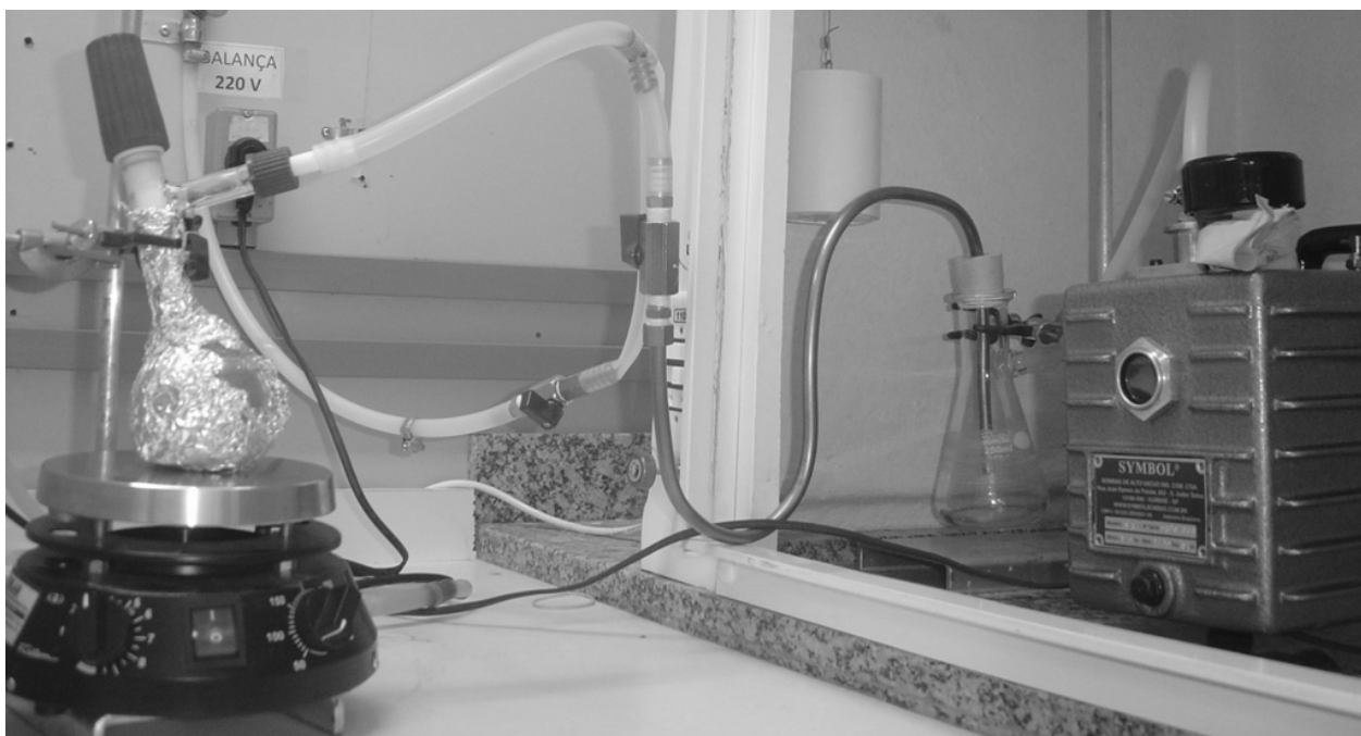
Figura 3.1. Sistema de purificação de líquido iônico. (À direita: bomba de vácuo; à esquerda: recipiente contendo líquido iônico sob agitação magnética.)
