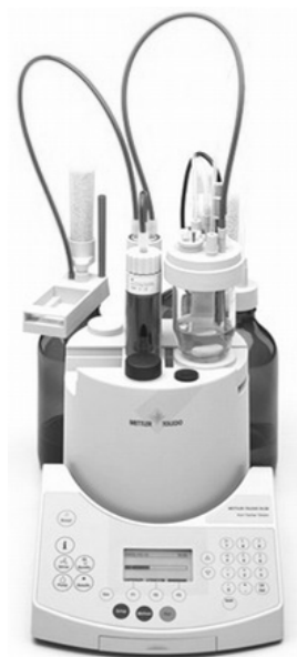
Figura 3.8. Titulador potenciométrico de Karl Fishcher, Mettler-Toledo, modelo DL 31. (Fonte: Mettler-Toledo, 2008a.)
