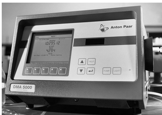
Figura 3.9. Densímetro Anton Paar, modelo DMA 5000. (Fonte: Anton Paar, 2008a.)
