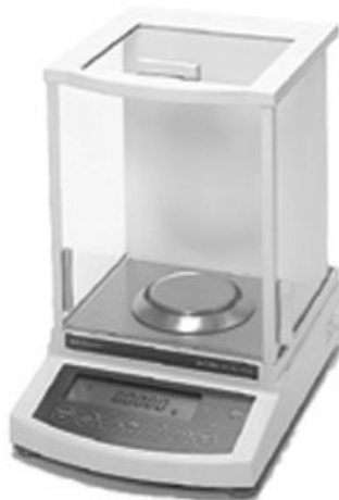
Figura 3.7. Balança analítica Shimadzu, modelo AX200. (Fonte: Shimadzu, 2009.)
