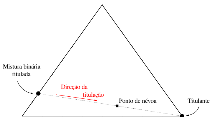
Figura 3.12. Esquema gráfico da determinação de um ponto de névoa.
