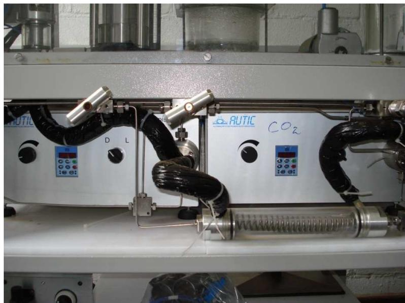
Figura 4.6: Foto das bombas pistão instaladas na planta piloto, sendo uma para o propano (esquerda na foto) e outra para o CO<sub>2</sub> (direita na foto).
