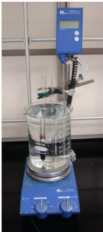
Figura 4.15: Esquema montado para a medição das viscosidades.
