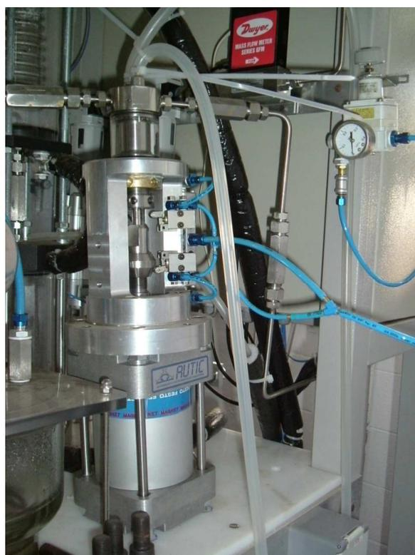
Figura 6.5: Foto da bomba do tipo *booster* para multiplicação de pressão (1:100). (a) Esquema da estrutura da bomba. (b) Foto da bomba instalada na planta piloto.
