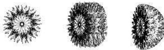
Figura 2.9: Possíveis estruturas micelares formadas por moléculas de asfaltenos e resinas na presença de hidrocarbonetos aromáticos (Priyanto et al. 2001).
