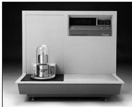
Figura 3. 7 - Equipamento DSC 2920 TA Instruments
