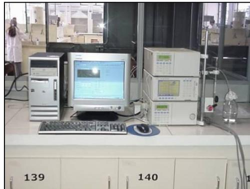
Figura 3. 8 - Cromatografia líquida de alta eficiência.
