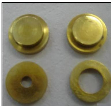
Figura 3. 2 – Molde metálico aberto
