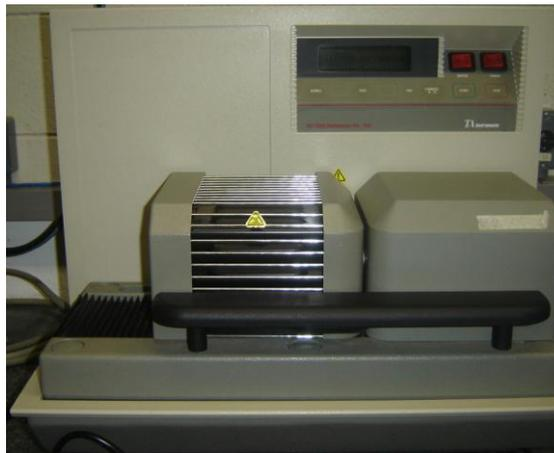
Figura 3. 6 – Equipamento de TGA 2960 TA Instruments
