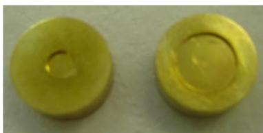
Figura 3. 3 – Molde metálico montado
