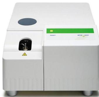
Figura 3.1. Foto do Calorímetro de varredura diferencial DSC 823e pertencente ao LOPCA/FEQ/UNICAMP.
