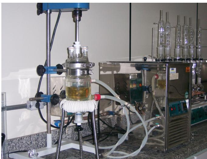
Figura 3.7. Montagem de reação de transesterificação.
