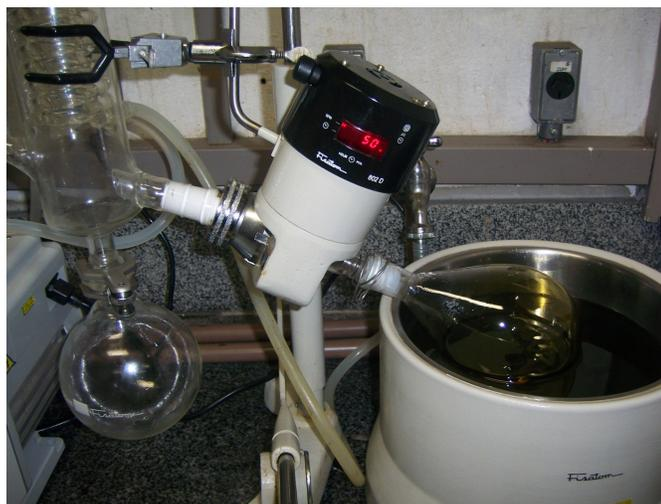
Figura 3.8. Rotoevaporação do produto da reação.
