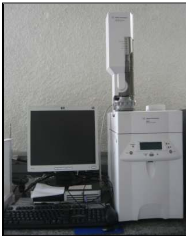
Figura 4.2 Cromatógrafo Gasoso FID. Fonte: LDPS/UNICAMP.
