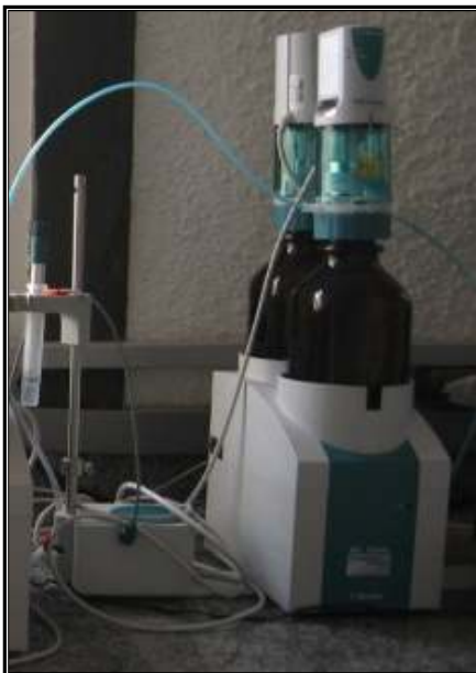
Figura 4.4 Titulador potenciométrico. Fonte: LDPS/UNICAMP
