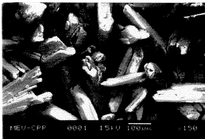
Figura 4.23 - Material seco no leito fluidizado agitado, corrida 8, ampliação 150x. T = 65^{\circ}\text{C} ; H_0 = 12\text{cm} ; X_0 = 40\%
