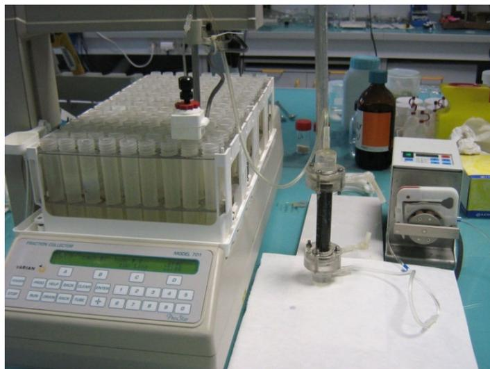
Figura 3.4 - Sistema experimental dinâmico (Laboratoire Génie de l'Environnement Industriel - École des Mines d'Alès, França).
